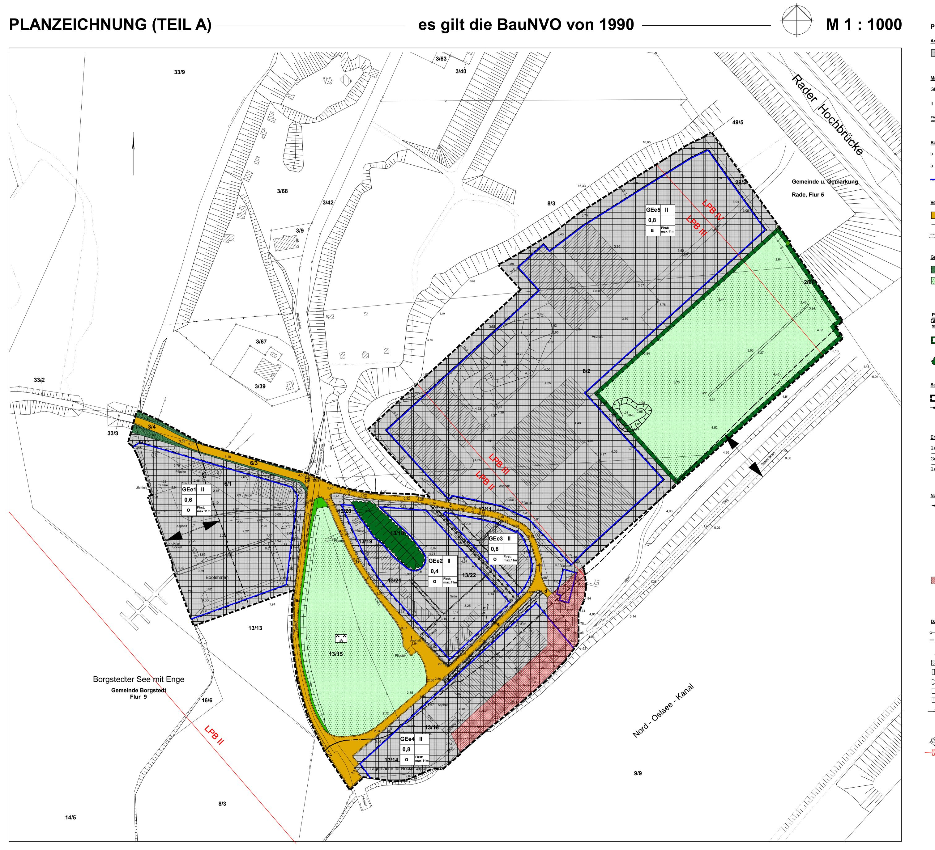
§1 Abs.6 BauNVO Maß der baulichen Nutzung GRZ 0.80 Grundflächenzahl, z.B. max. 0.80 §16 + 19 BauNVO Zahl der Vollgeschosse, z.B. max. 2 §16 + 20 BauNVO First: Firsthöhe als Höchstmaß, z.B. max. 11,00 m §16 + 18 BauNVO Bauweise, Baulinien, Baugrenzen
